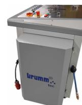
Bsp.: Aufrollbarer Elektro- und Druckluftanschluss
